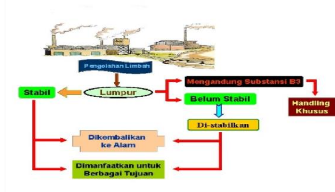
Gambar 18.4. Upaya untuk menstabilkan lumpur yang dihasilkan pada pengolahan limbah
