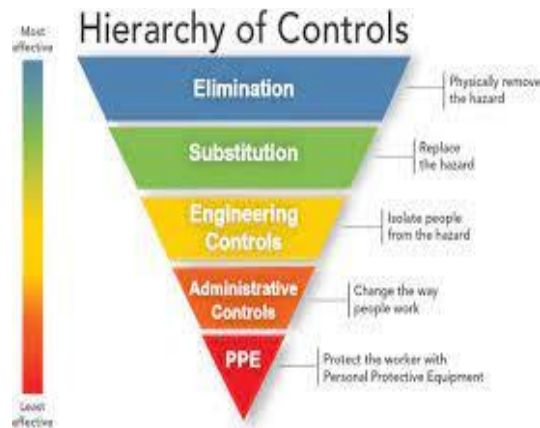
Gambar 1. Hierarki Pengendalian Risiko K3 dari NIOSH (National Institute For Occupational Safety and Health) (Peraturan Menteri Kesehatan Republik Indonesia Nomer 52 Tahun 2018 Tentang Keselamatan Kerja Di Fasilitas Pelayanan Kesehatan, 2018)
