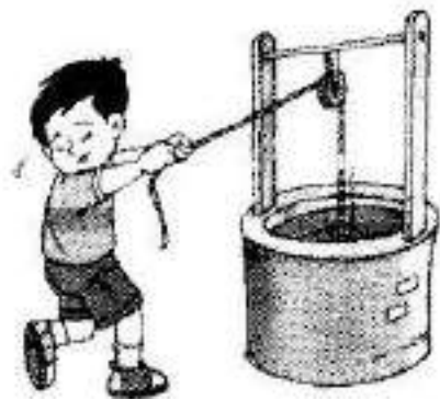
Sumur gali dengan kerekan tali
