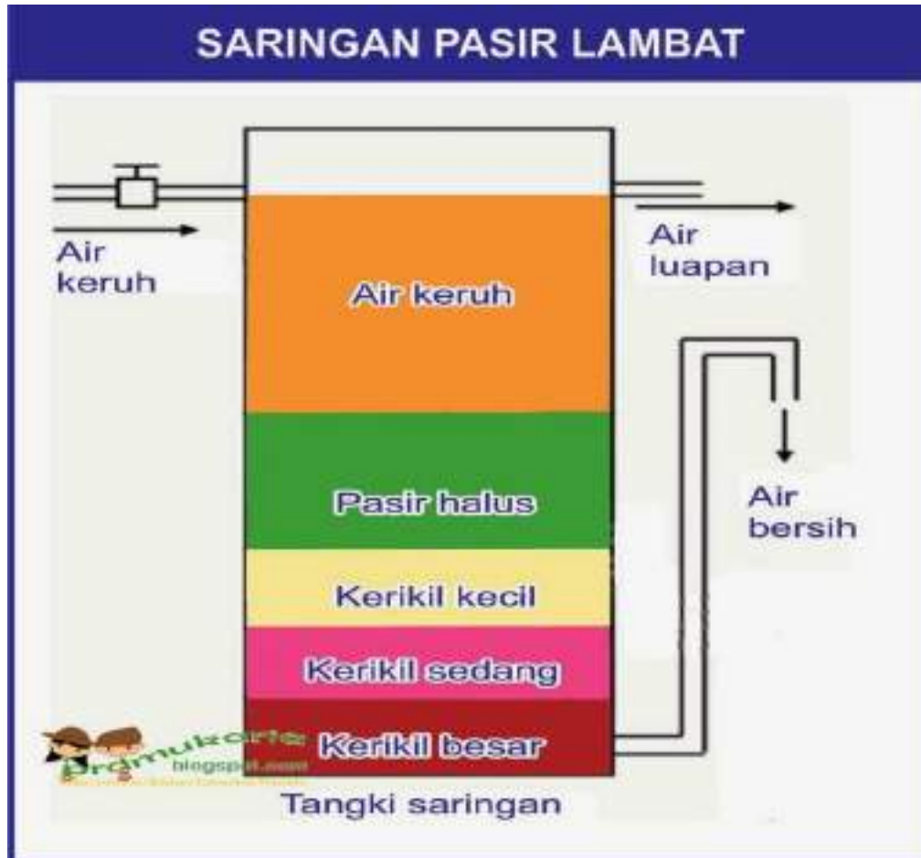
Gambar 1.38: Proses Pengolahan Air Bersih dengan pasir+ lambat https://www.google.com/search?q=Gambar+pengolahan+air
