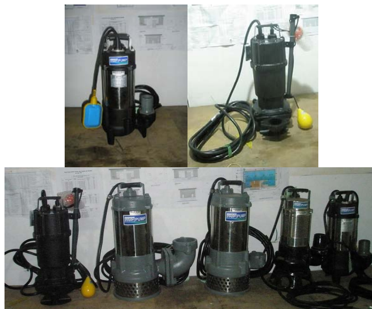
Gambar 3.16 : Jenis Pompa Celup Yang Sering Digunakan Untuk Pengolahan Air Limbah.
