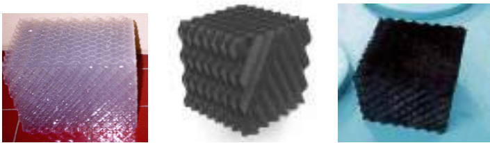
Gambar 2.14 : Bentuk Media Terstruktur Tipe Sarang Tawon ( Cross Flow ) Yang Banyak Digunakan Untuk Biofilter.
