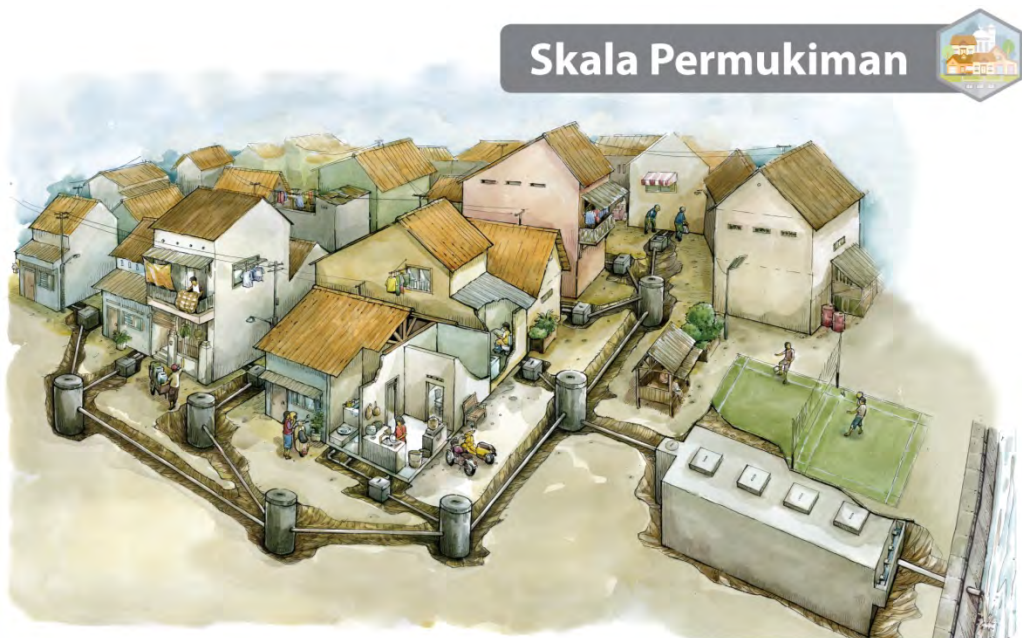
Gambar 7: Sistem Pengelolaan Air Limbah Domestik Skala Permukiman.
