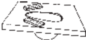
sekat air diletakkan di bawah lantai beton
