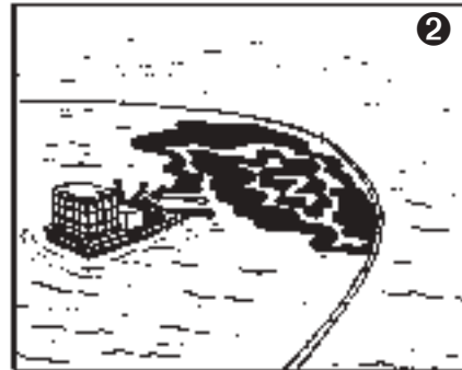
Sebuah mesin yang dinamakan "skimmer" mengangkut minyak dari permukaan air dan menyedotnya melalui sebuah selang ke dalam tangki penampung limbah.
