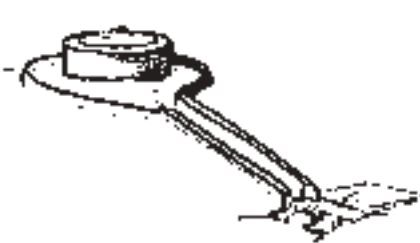
5. Lubang air yang ditutup dengan pelataran dan saluran air
