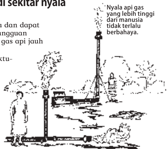
Nyala api gas yang setinggi manusia atau letaknya horizontal terhadap tanah sangat berbahaya
