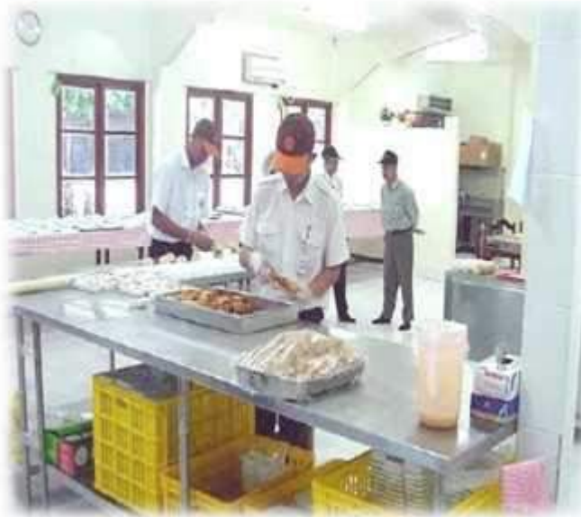
Gambar 20. Contoh meja kerja terbuat dari stainless steel
