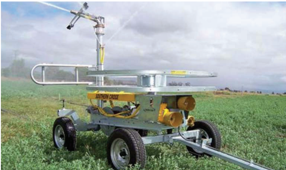
Penyiram bergerak yang umum digunakan di tambang bijih besi di wilayah Pilbara Australia Barat. Sumber: Panduan Operatora Southern Cross SX2500 3500 V2.
