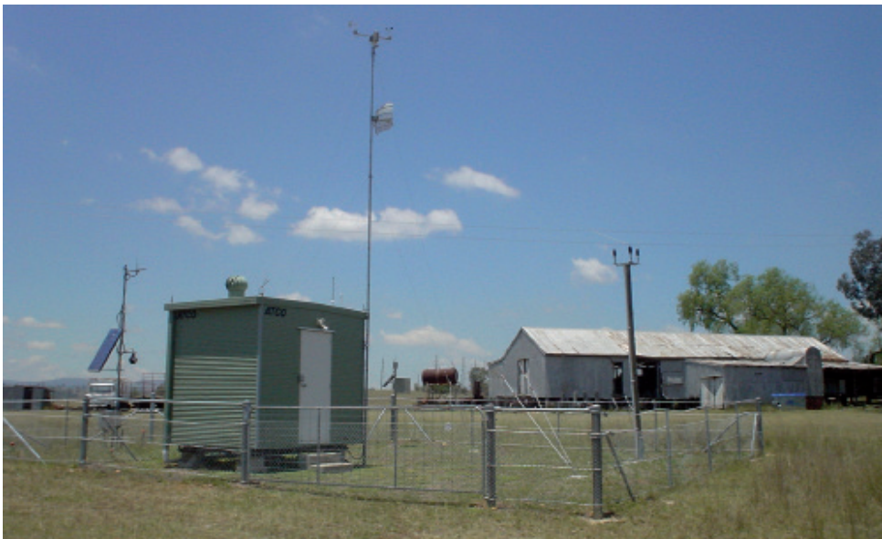
Stasiun pemantauan jarak jauh mencakup instrumen kebisingan dan cuaca dan komunikasi nirkabel. Sumber: Wilkinson Murray.
